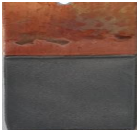
Сурет 2 - Титан диоксидінің дисперсті бөлшектері бар композициялық мырыш жабынының фотосуреті.
